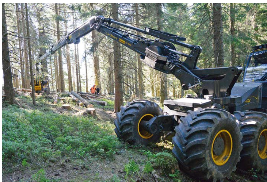
Oben: Herzog konstruierte für den Kran C55 einen neuartigen Langausleger mit innenliegender Schlauchführung mit 14 Meter Reichweite. Links: Seitlich am Kran ist die spezielle Schlauchwicklung zu sehen.
