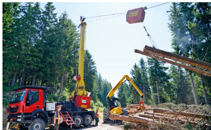
Ein Arbeitsbild mit dem Mouty 5000. Im Hintergrund arbeitet der Highlander das herangeseilte Holz auf.
