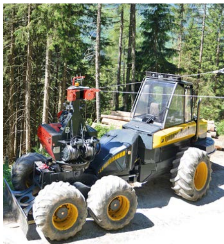
Oben: Harvester Ponsse Bear mit Herzog-MW-500-Traktionswinde. Rechts: Forwarder Ponsse Buffalo mit Herzog Synchronwinch.
