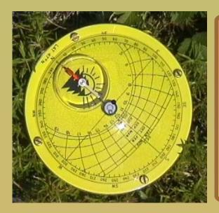
Der Sonnenkompass besteht aus einer gelb eloxierten Aluminiumscheibe von 116 mm Durchmesser mit einer schwarz aufgedruckten Skala.
